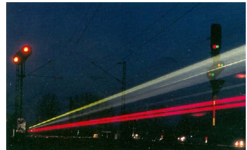
Voorbeeld van het grootbedrijf van een bloksein met voor- en hoofdsein op één mast. In dit geval bevestigt het nu niet de toewijzing van een adres, maar door de lange tijd van sluiteropening van de camera zijn alle seinbeelden tegelijk te herkennen.
