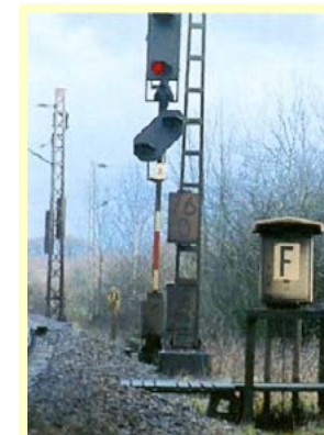
Geeft het sein “stop” weer—het inrijsein is dus versperd— dan blijven de lampen van het voorsein gedoofd.
