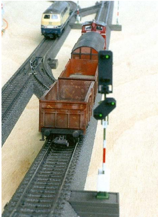
Het inrijspoor is hier vrij. Dat betekent tevens, dat het voorsein hetzelfde adres als N1 heeft gekregen.
