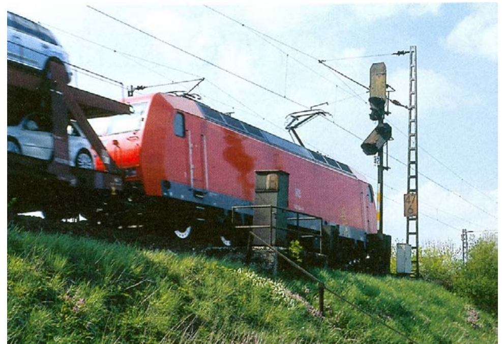
De telefoon heeft door haar grote breedte een behoorlijk fundament nodig. Let ook op de betonnen trap met houten leuningen. Dit sein (42) staat in de tegengestelde telrichting.
